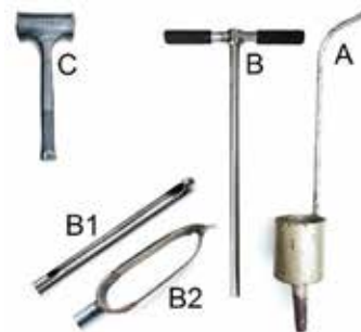
Figura N° 7. Tipos de barrenos. A: para capa arable. B1: tubular. B2: helicoidal. C: mazo o martillo.
