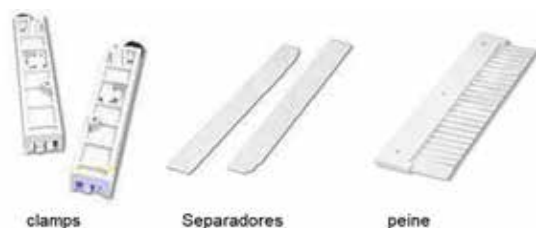
Figura N° 3. Materiales para el armado del gel de DGGE (Bio-Rad Laboratories, 1996).
