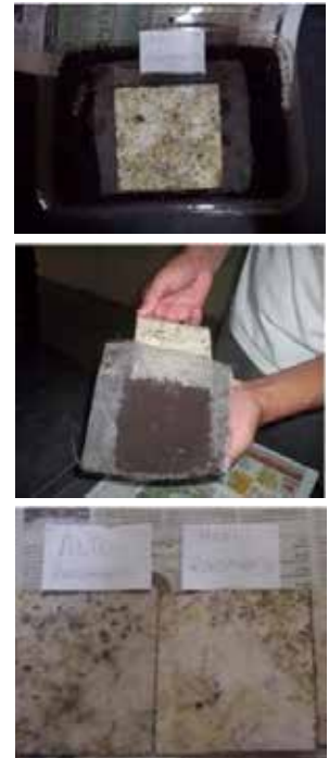
Figura N° 7. Degradación en laboratorio con humedad controlada, control a los 15 días (Cátedra de Microbiología Agrícola de la FCA-UNNE).
