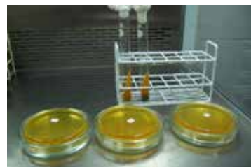
Figura N° 8. Medio con Azul de bromotimol, reacción ácida en tubos y en placas de Petri.
