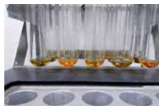
Figura N° 8. Extracto luego de la digestión, en el que se observan distintas coloraciones según el contenido de biomasa microbiana.
