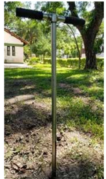
Figura N° 6. Posición correcta del barreno para la toma de muestra.
