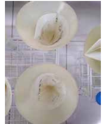
Figura N° 5. Filtrado de la muestra con filtro banda azul.
