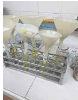
Figura N° 3. Filtrado del suelo.
